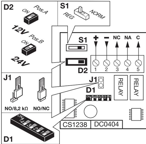
**Connessioni proiettore - Transmitter connections**
